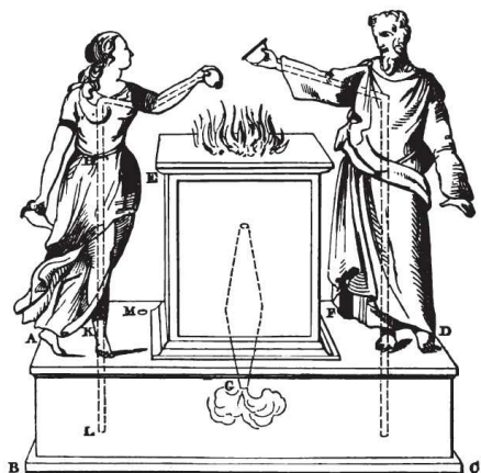
7. Libaciones en un altar, producidas por el fuego. Mecanismo descrito por Herón de Alejandría.
